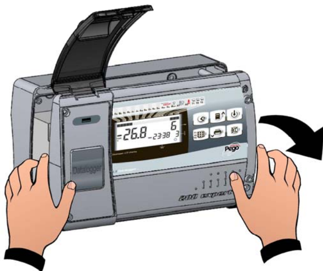
Abb. 3: Öffnen Sie die Vorderseite des Gehäuses durch Anheben und Herausziehen der beiden Kunststoffscharniere. Drehen Sie die Front des Gehäuses um 180° nach unten. Sie erhalten jetzt Zugang zum Inneren des Gerätes.
